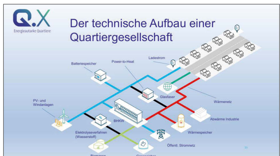
Abb. 1: Schematische Darstellung des Q.X Quartierskonzeptes für eine CO 2 -neutrale Versorgung mit Strom und Wärme unter Einbindung verschiedener Elemente der Sektorkopplung. (Abb. 1 © Q.X Project GmbH)
